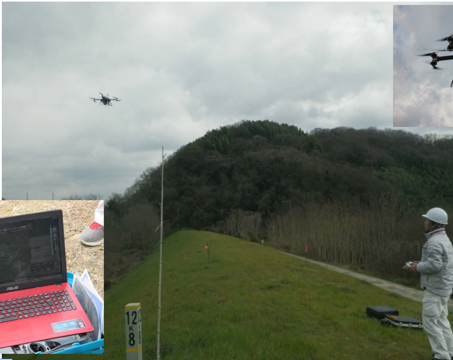
ドローンによる測量状況
