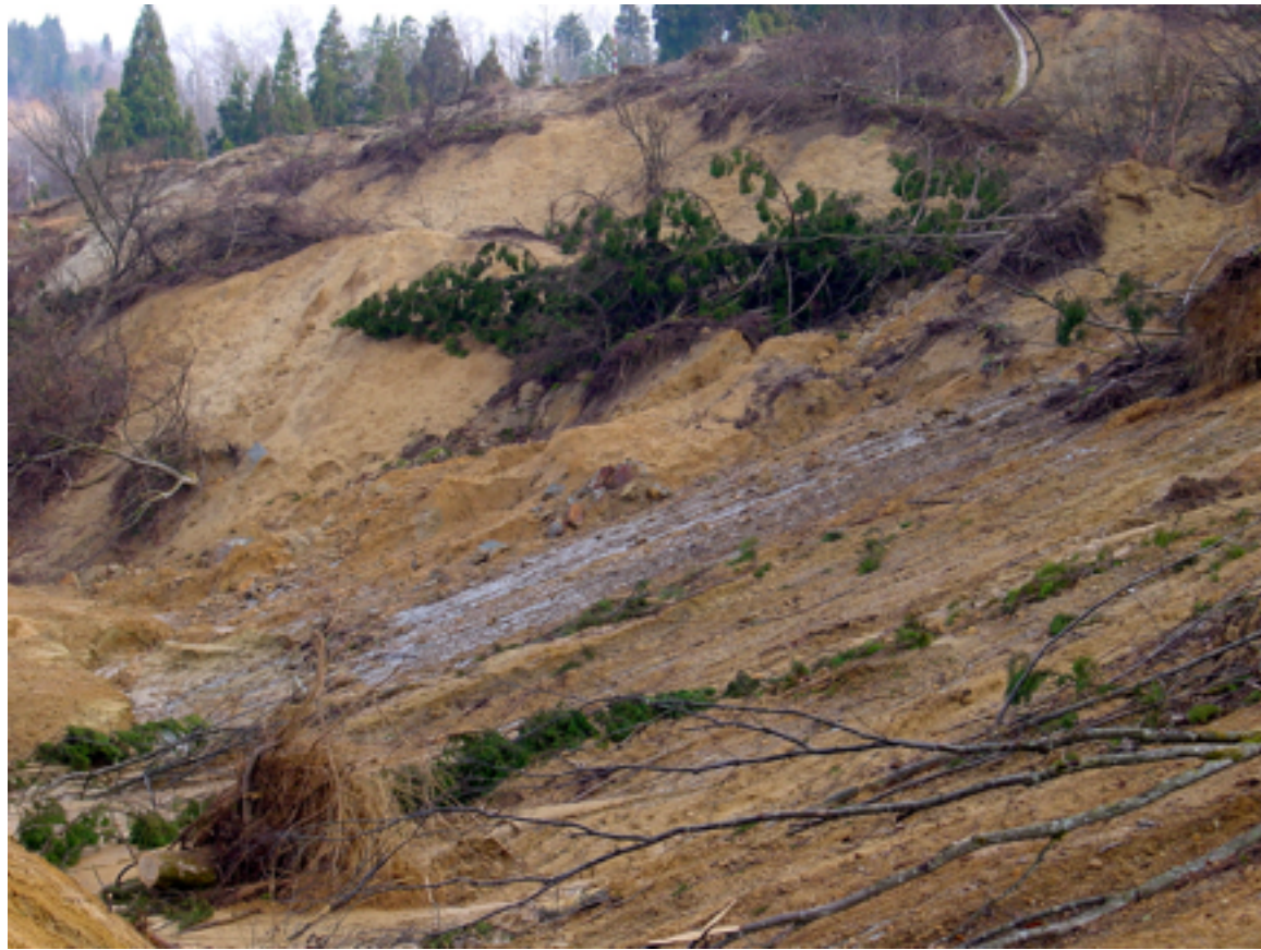
泥岩を滑り面とした流れ盤
